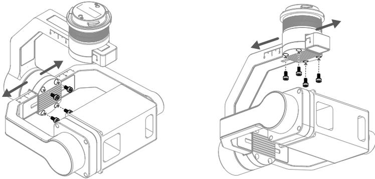
6. 剪去 Y 轴多余防水片，保证预留 1 mm 左右槽宽；撕去离型纸，将防水片贴合到 Y 轴臂凹槽内。
