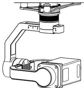
⚠ 移除云台时，需要按住解锁按钮，才能旋转云台的快拆接口。为方便下次安装，请在移除云台时，务必将接口旋转到位再取下云台。
